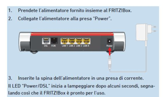
Il FRITZ!Box è un router internet per la connessione DSL:
